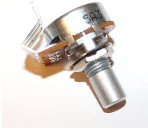
Die einfachste Art die Potentiometer zu montieren ist immer nur das mittlere Pin eines Potentiometers fest zulöten, um die Potentiometer und die Platine hinterher noch im Gehäuse ausrichten zu können.
